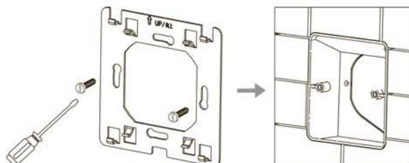
4) После подключения терморегулятора к проводам, закрепите прибор на крепежной пластине и наденьте лицевую панель и рамку.
