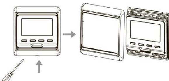
2) При помощи отвертки снимите заднюю крепежную пластину, как показано на рисунке.
