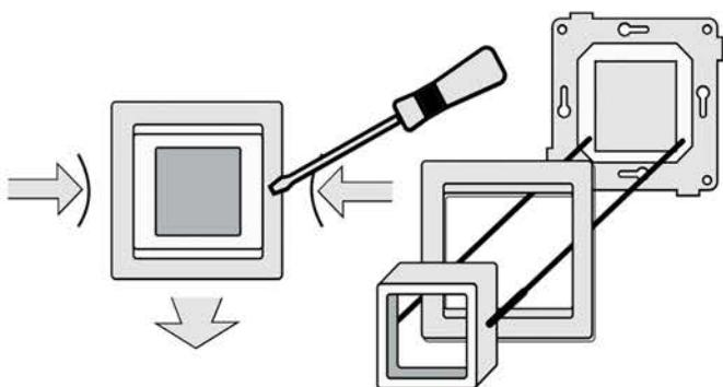
Способ монтажа должен обеспечивать возможность беспрепятственной замены датчика температуры.
