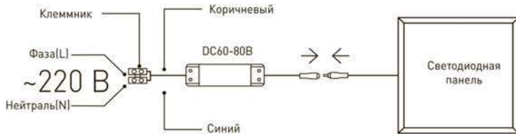
Рис.1. Схема подключения светодиодной панели к сети 220В.
