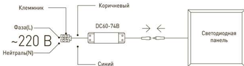
Рис.1. Схема подключения светодиодной панели к сети 220В.
