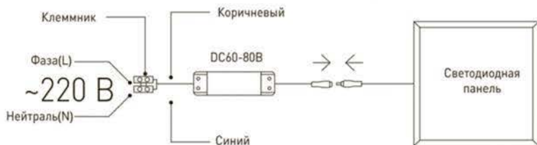
Рис.1. Схема подключения светодиодной панели к сети 220В.
