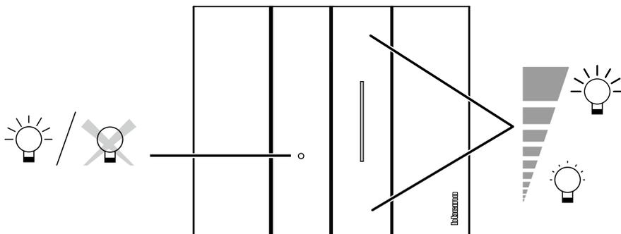
Включите и выключите свет и простым нажатием создайте требуемый уровень освещённости. Возможность установки разных уровней яркости. Светодиодный индикатор ВКЛ/ВЫКЛ.
