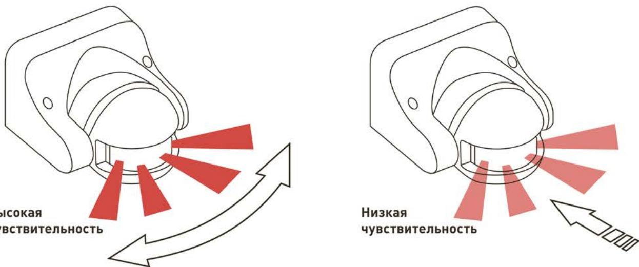
Рисунок 4. Зоны чувствительности датчика движения.
