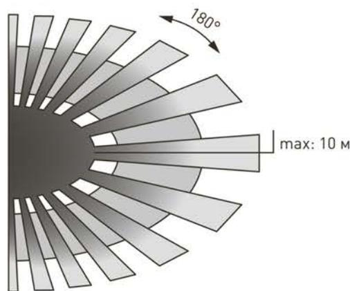
Рисунок 2. Схема зоны обнаружения.
