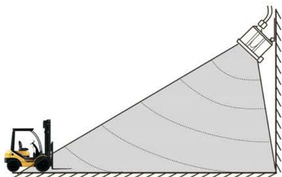
Высота установки датчика: 4–15 м
