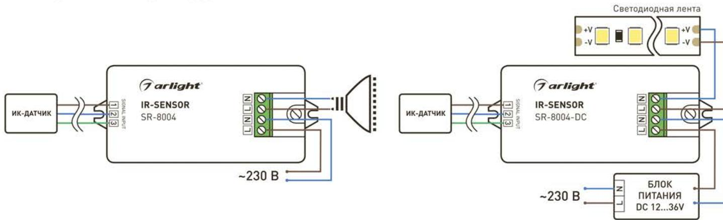
Рис. 1. Подключение датчика SR-8004.
