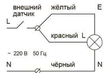
в) Схема подключения при использовании внешнего датчика с полным отключением светильника
