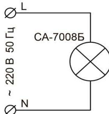
*Рисунок 6 — Схема подключения светильника CA-7008Б*
