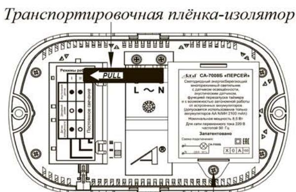
*Винт фиксации крышки аккумуляторного отсека*
