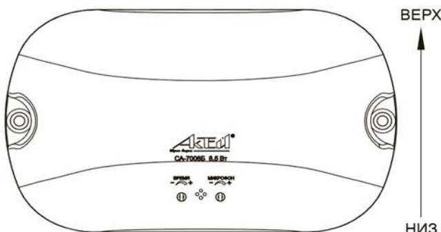
*Рисунок 3 — Расположение светильника CA-7008Б при установке на стене*
