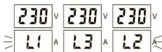
Рис. 5 Дисплей в случае неправильного порядка чередования фаз
