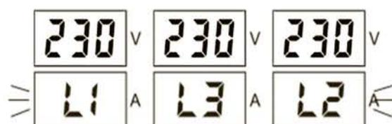
Рис. 5 Дисплей в случае неправильного порядка чередования фаз
