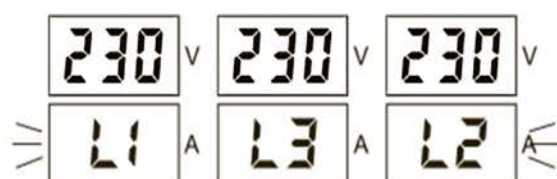
Рис. 5 Дисплей в случае неправильного порядка чередования фаз
