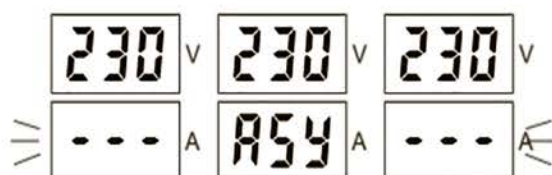
Рис. 13 Дисплей в случае асимметрии
