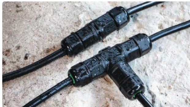
**Герметичные кабельные коннекторы Navigator серии NTB-IP68** предназначены для соединения и распределения электрических проводников, требующих обеспечения полной герметичности электрической цепи. Благодаря степени защиты от влаги и пыли IP68 коннекторы могут использоваться под водой и под землей без угрозы потери качества соединения. Основной областью применения являются промышленное и уличное освещение.
