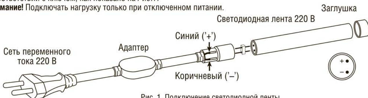
Рис. 1. Подключение светодиодной ленты.
