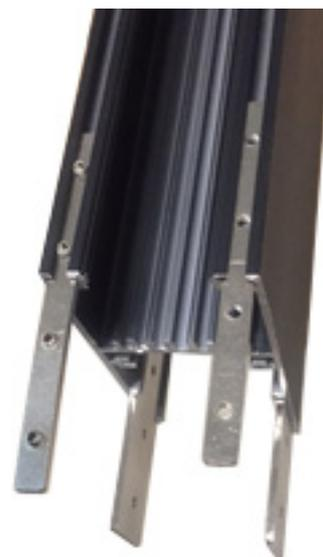
Установите в пазы шинопровода [3] коннекторы SIDE [2] и UP [1] на половину их длины и закрепите установочными винтами из комплекта поставки. При затягивании установочного винта закрутите его до контакта, а затем доверните на 90°. Установите последующий шинопровод, совместив коннекторы с соответствующими пазами на шинопровode, плотно сведите шинопроводы в месте соединения и зафиксируйте коннекторы установочными винтами, как описано выше.
