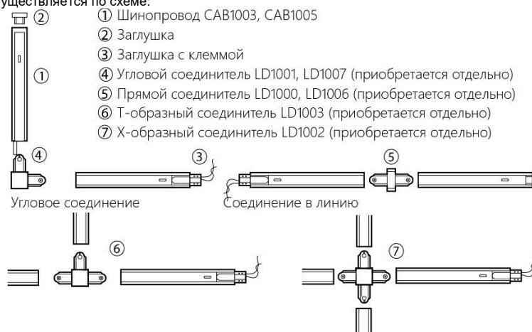
4.9 Установите светильники на шинопровод. Для предотвращения появления повышенных механических напряжений в конструкции шинопровода, светильники необходимо распределять равномерно по всей длине.
