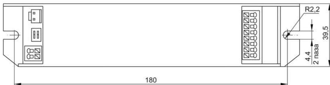
Рисунок 1 – Конвертер БАП200-1,0(3,0)
