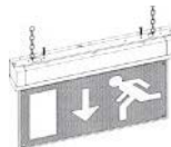
Потолочное крепление на цепь (гибкий подвес ST 50)
