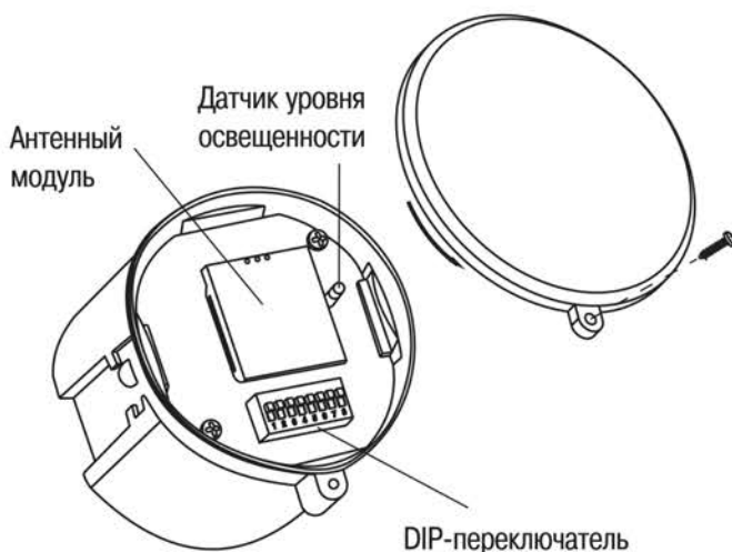
Рисунок 15 – Схема подключения датчика ДД-МВ601
