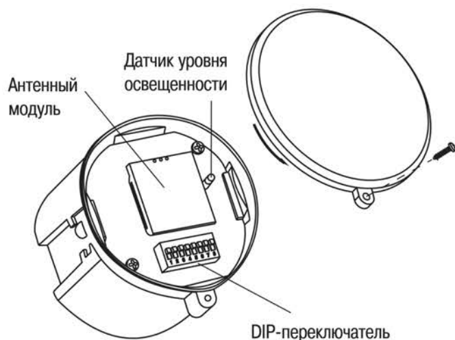
Рисунок 15 – Схема подключения датчика ДД-МВ601
