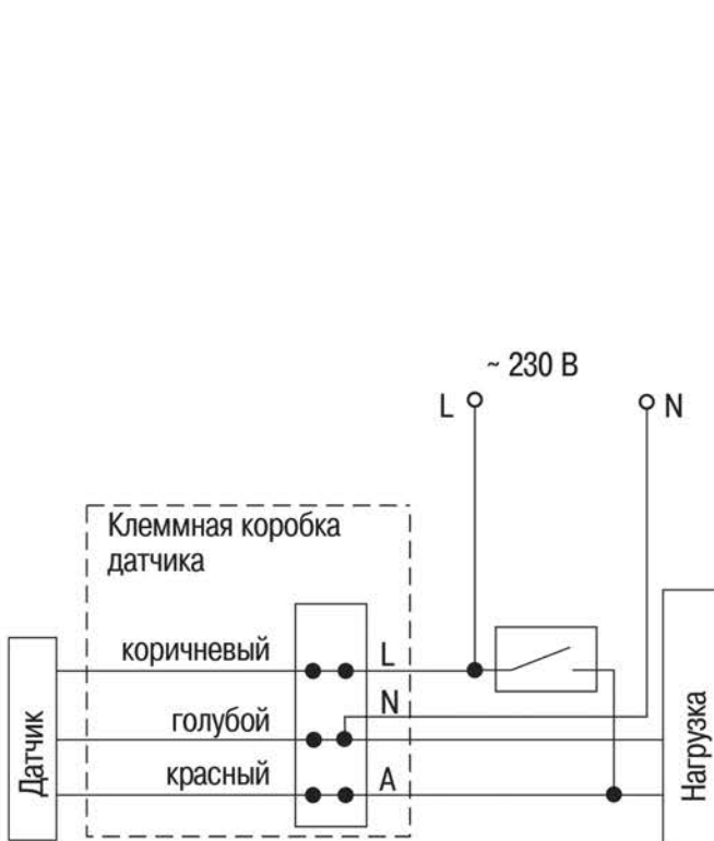
Рисунок 27 – Схема режима постоянного включения нагрузки
