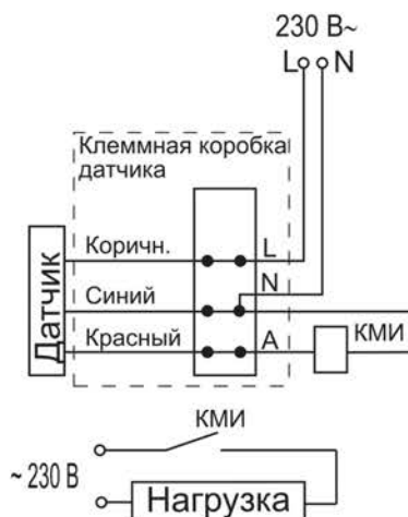
Рисунок 8 – Схема подключения датчиков с контактором КМИ
