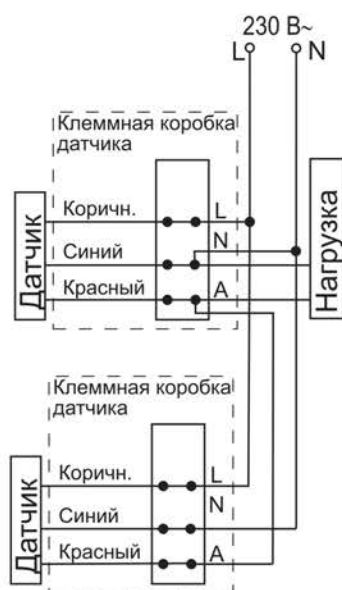
Рисунок 6 – Схема параллельного подключения датчиков движения
