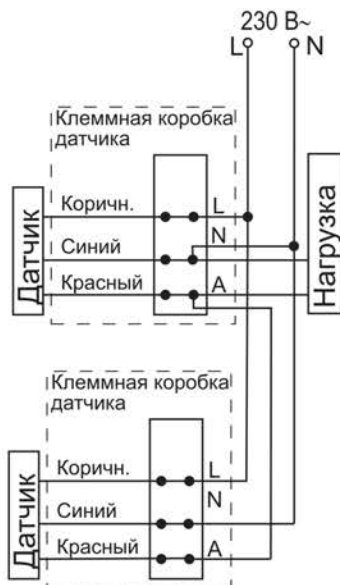
Рисунок 6 – Схема параллельного подключения датчиков движения
