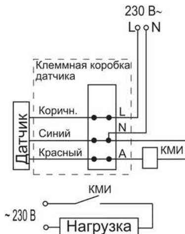
Рисунок 8 – Схема подключения датчиков с контактором КМИ
