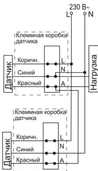
Рисунок 6 – Схема параллельного подключения датчиков движения
