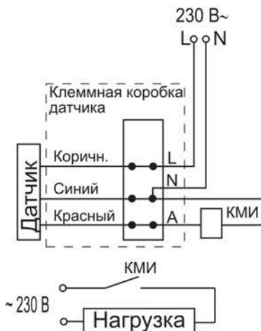
Рисунок 8 – Схема подключения датчиков с контактором КМИ
