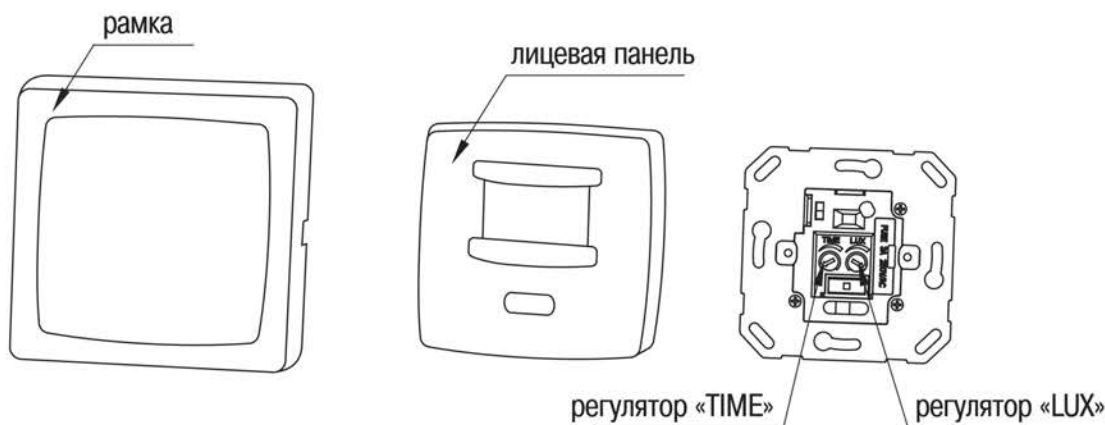
Рисунок 13 – Конструкция датчика движения ДД-030
