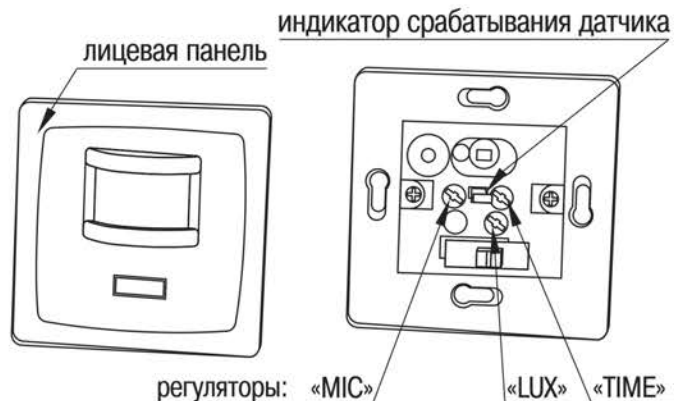
Рисунок 15 – Конструкция датчика движения ДД-035
