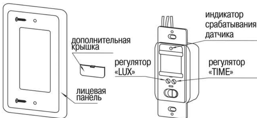
Рисунок 11 – Конструкция датчика движения ДД-028
