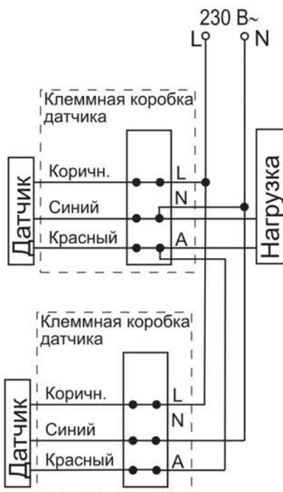
Рисунок 19 – Схема параллельного подключения датчиков
