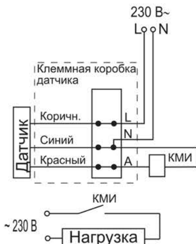
Рисунок 21 – Схема подключения датчика с контактором КМИ
