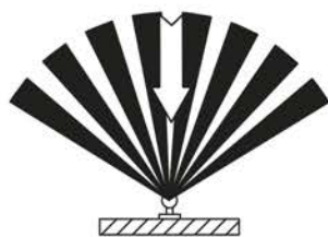
Рисунок 15 – Чувствительность датчиков движения
