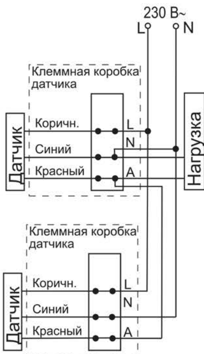
Рисунок 19 – Схема параллельного подключения датчиков
