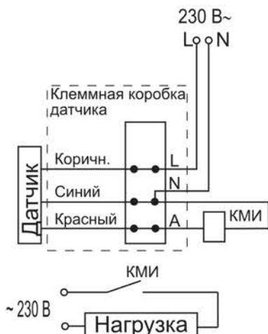
Рисунок 21 – Схема подключения датчика с контактором КМИ
