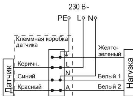
Рисунок 18 – Схема подключения датчиков ДД-017, ДД-019
