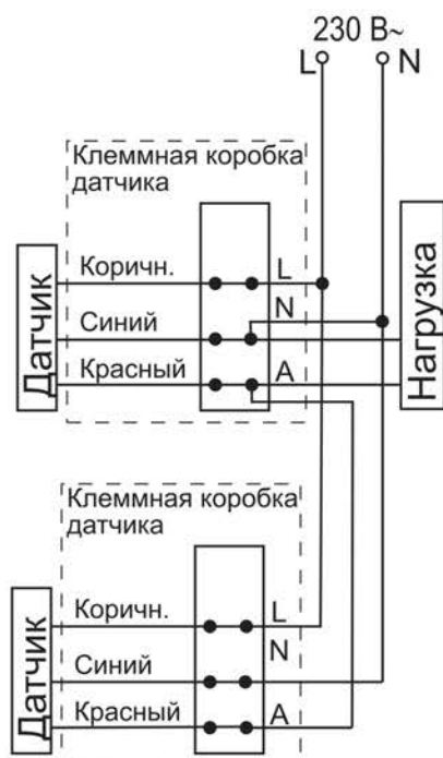
Рисунок 19 – Схема параллельного подключения датчиков
