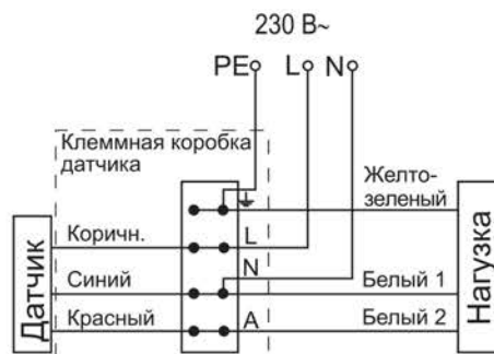
Рисунок 18 – Схема подключения датчиков ДД-017, ДД-019
