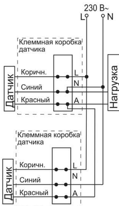
Рисунок 19 – Схема параллельного подключения датчиков
