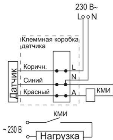
Рисунок 21 – Схема подключения датчика с контактором КМИ
