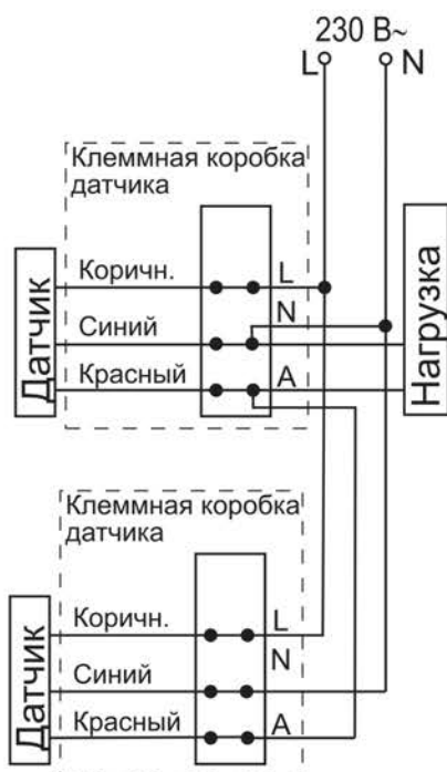
Рисунок 19 – Схема параллельного подключения датчиков
