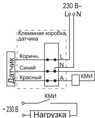
Рисунок 21 – Схема подключения датчика с контактором КМИ
