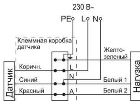
Рисунок 18 – Схема подключения датчиков ДД-017, ДД-019
