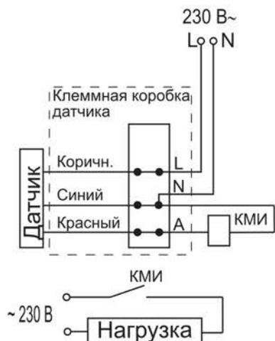
Рисунок 21 – Схема подключения датчика с контактором КМИ
