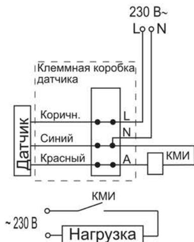
Рисунок 21 – Схема подключения датчика с контактором КМИ
