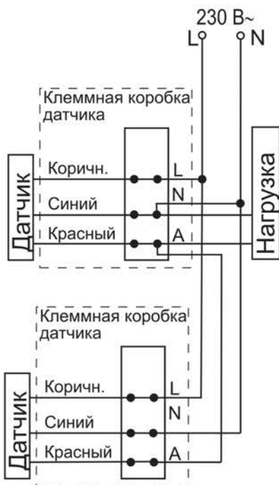
Рисунок 19 – Схема параллельного подключения датчиков
