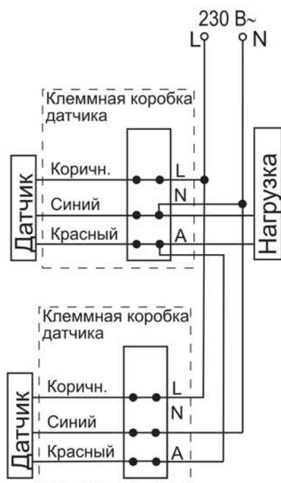
Рисунок 19 – Схема параллельного подключения датчиков
