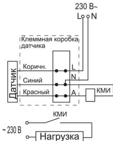
Рисунок 21 – Схема подключения датчика с контактором КМИ
