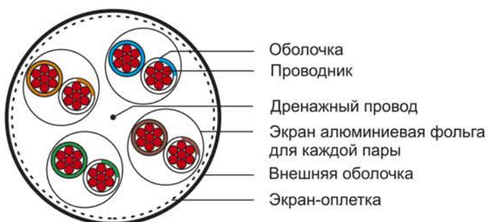
Рисунок 6 – Конструкция патч-корда категории 6A типа S/FTP
