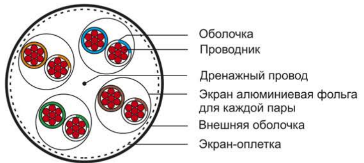
Рисунок 6 – Конструкция патч-корда категории 6A типа S/FTP
