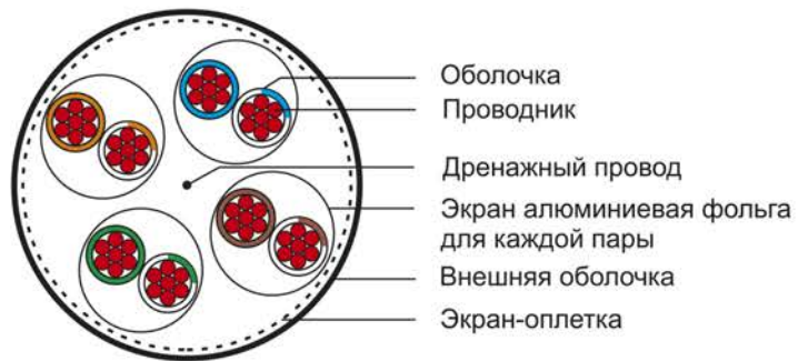
Рисунок 6 – Конструкция патч-корда категории 6A типа S/FTP
