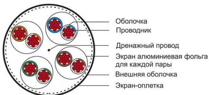
Рисунок 6 – Конструкция патч-корда категории 6A типа S/FTP
