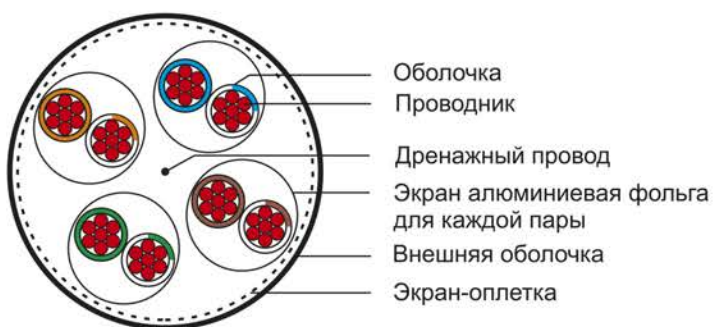
Рисунок 6 – Конструкция патч-корда категории 6A типа S/FTP
