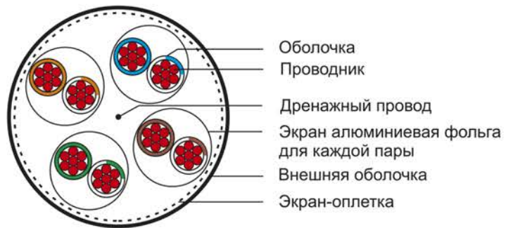
Рисунок 6 – Конструкция патч-корда категории 6A типа S/FTP
