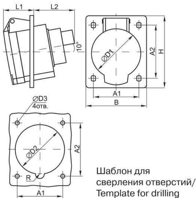
Рисунок 3 – Розетки штепсельные встраиваемые ССИ: 413, 414, 415, 423, 424, 425/ Figure 3 – Flush industrial sockets SSI-413 ÷ SSI-425 types
