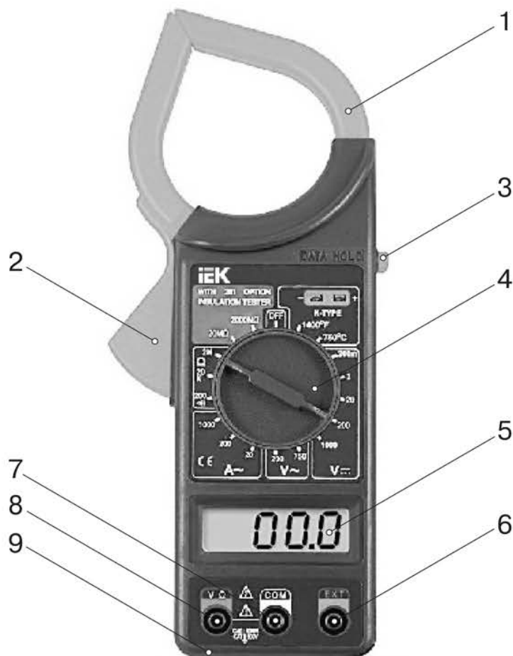
Рисунок 1 – Элементы лицевой панели клещей
