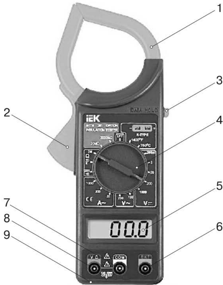
Рисунок 1 – Элементы лицевой панели клещей
