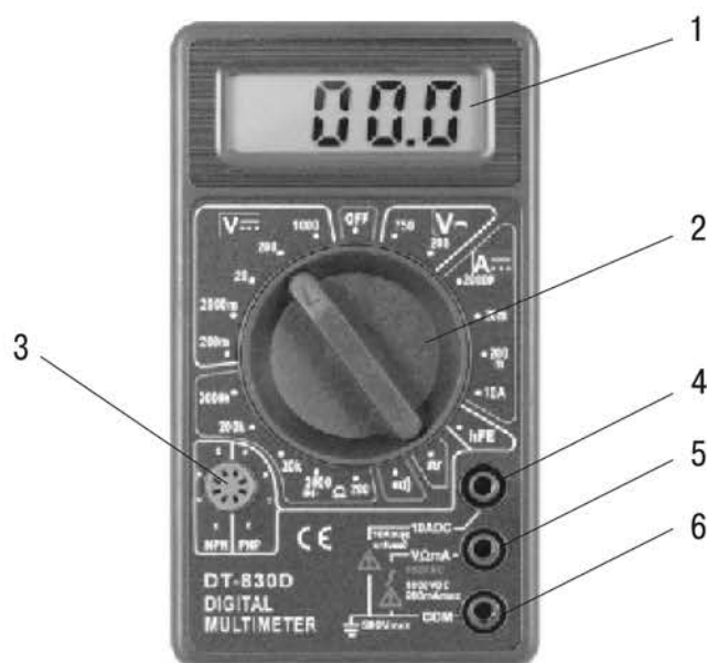
Рисунок 1 – Элементы лицевой панели мультиметров
