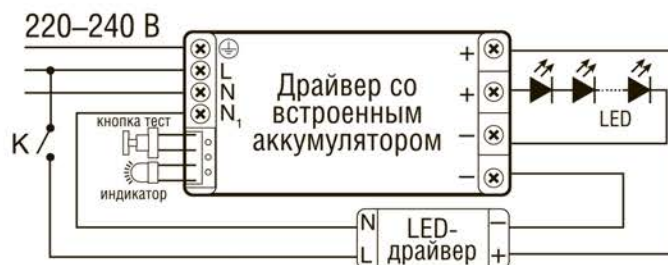
Схема подключения БАП в светильнике DSP-AC-40-IP65-LED-A1
