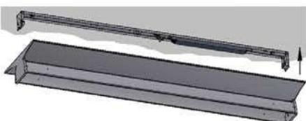
**5** Вставить лампу (лампы). Закрепить решетку (при наличии) в корпусе светильника при помощи пружин или защелкнуть ее на лампе при помощи суппортов. Вставить рассеиватель (при наличии).
