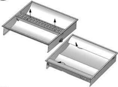
**2** Провести сетевые провода через отверстие в корпусе. Закрепить светильник на потолке (для светильников OTW и OTS) или установить его в потолочной нише:
