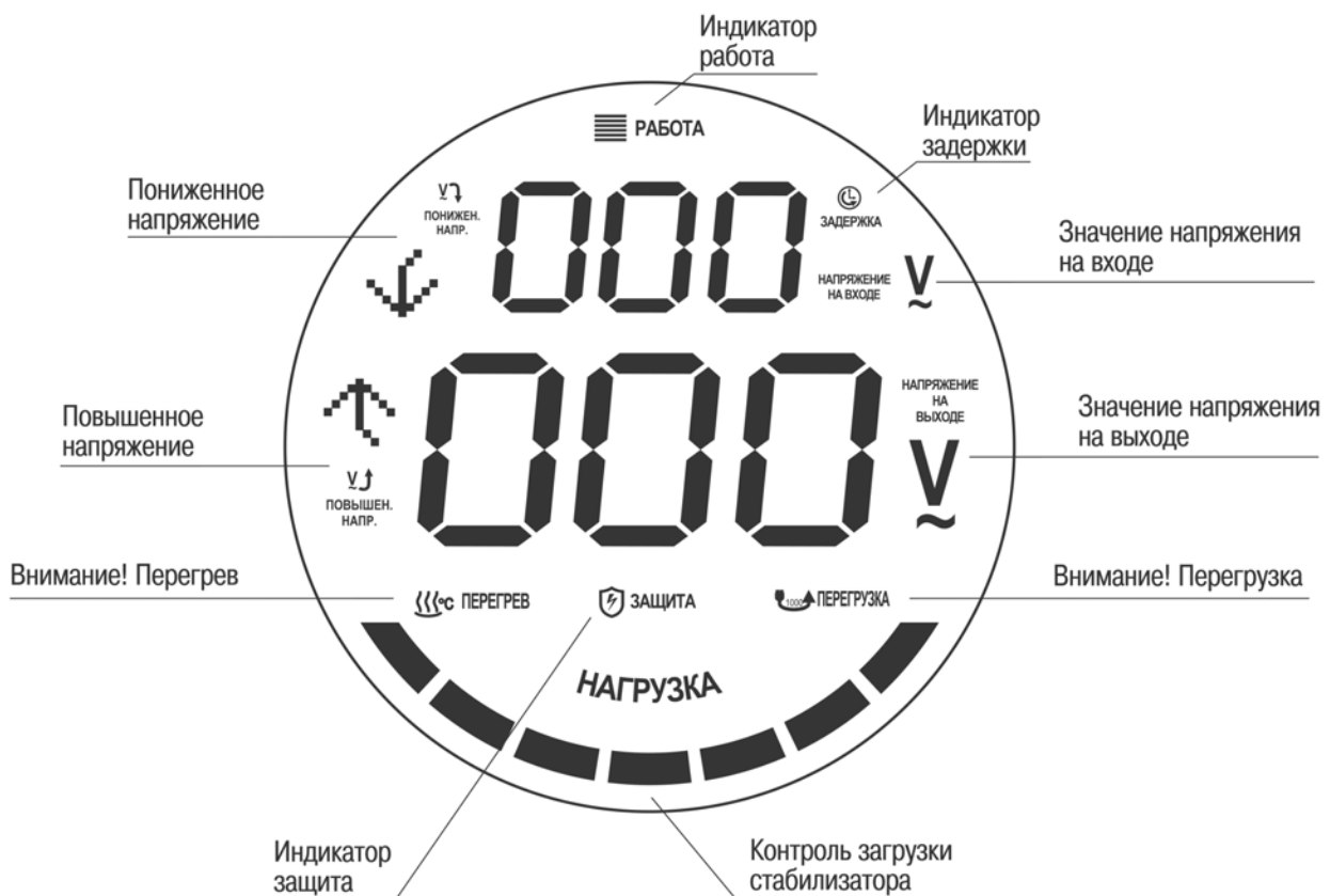
Рис 3. Индикация режимов работы переносных стабилизаторов
