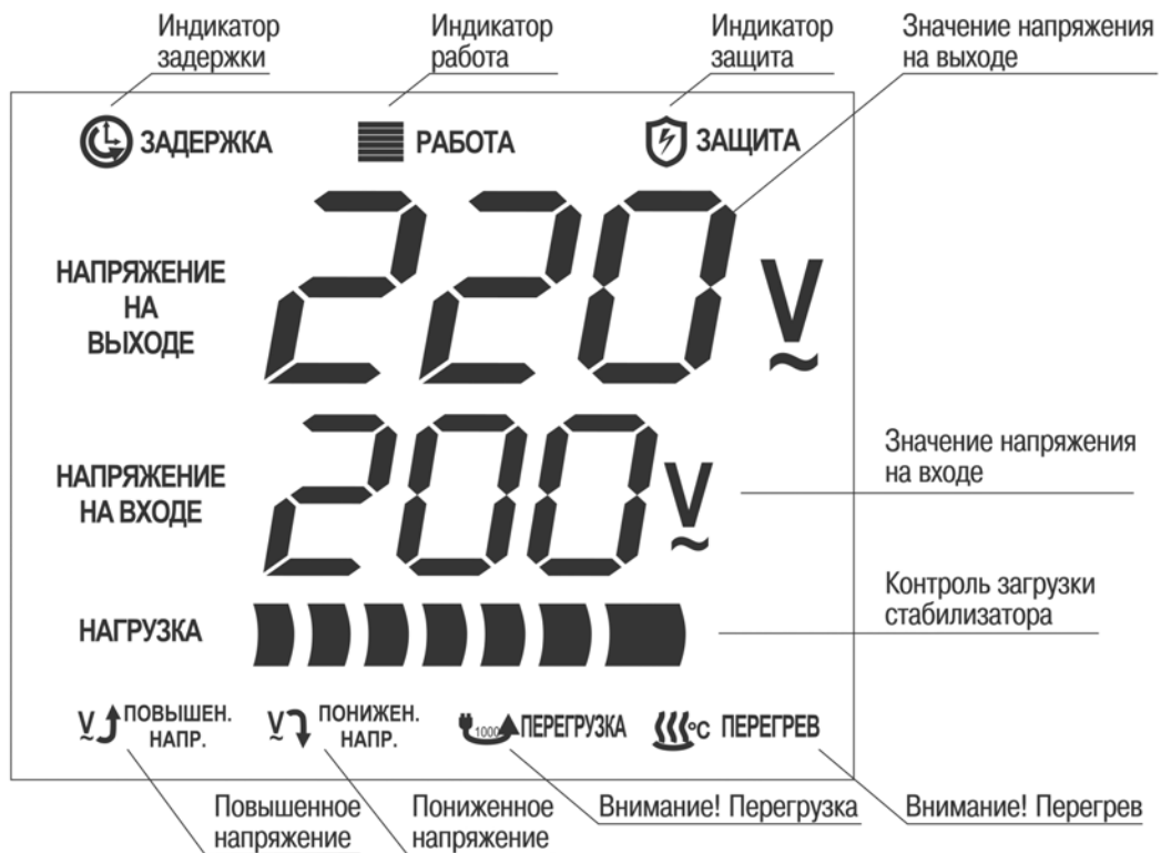
Рис 2. Индикация режимов работы настенных стабилизаторов
